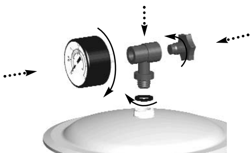
Montaje manómetro (con válvula lateral)
